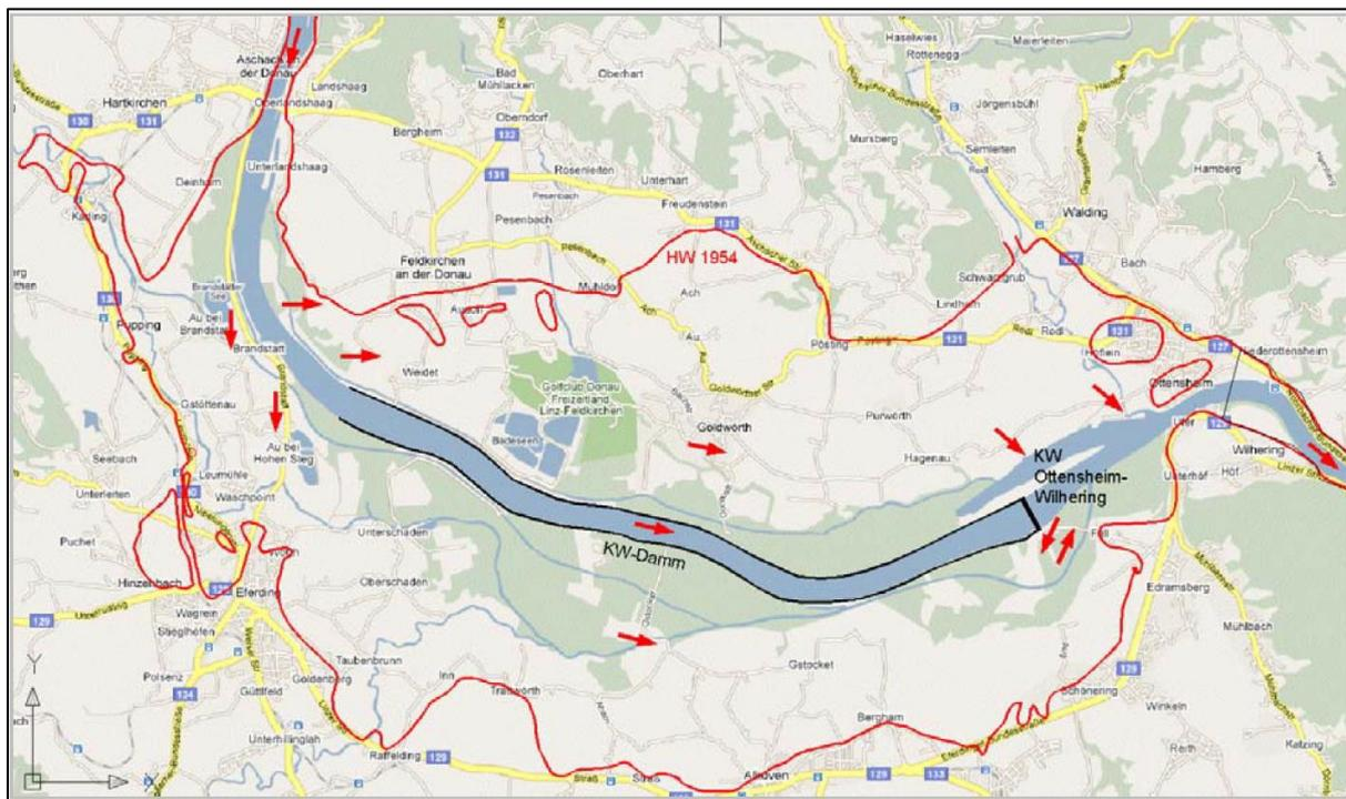
Abbildung 15: Hochwasserraum Eferdinger Becken 1954 sowie Retentionsraum: Ab HQ<sub>5</sub> überströmt die Donau die an der Stauwurzel befindlichen Überströmstrecken und flutet das Vorland (aus: Habersack et al 2010, Retentionsraumanalysen an der österreichischen Donau im Zusammenhang mit der EU Hochwasserrichtlinie).
