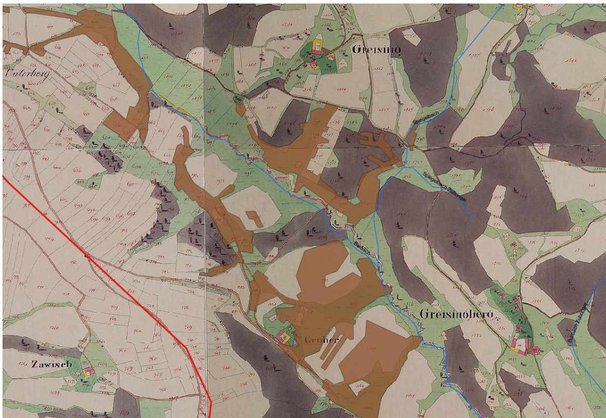
Abbildung 19: Überlagerung Vorteilsflächen des Meliorationskatasters (braun dargestellt) mit der Urmappe (Quellen: Doris), Bereich Greising.
