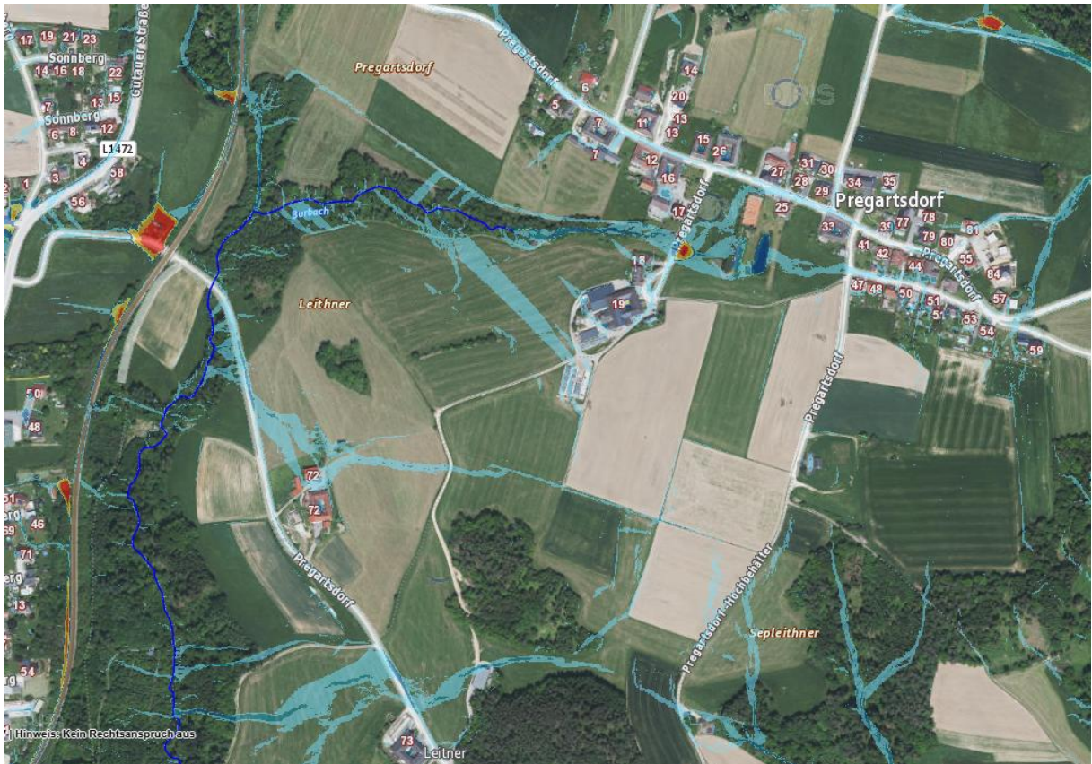
Abbildung 21: Hangwasserhinweiskarte, Bereich Pregartsdorf (Quelle: Doris, abgerufen November 2024).
